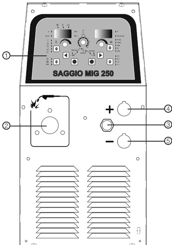
1. ПАНЕЛЬ УПРАВЛЕНИЯ АППАРАТА: ИНФОРМАЦИОННЫЙ ДИСПЛЕЙ, ВЫБОР ФУНКЦИЙ И ПАРАМЕТРОВ ПРОЦЕССА СВАРКИ И Т.Д.
