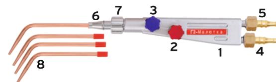
⚠ Внимание! В горелке используется смесительное устройство безинжекторного типа (равного давления), для которого необходимо устанавливать одинаковые давления кислорода и ацетилена на входе в горелку. Увеличение разности давлений ацетилена и кислорода снижает стойкость горелки к возникновению внутреннего горения (обратного удара).
