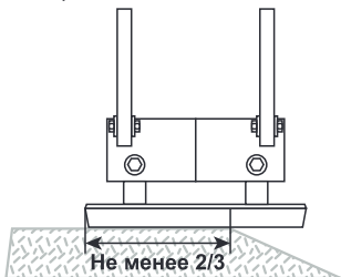
Рис. 12 Расположение виброплиты на краю обрабатываемой поверхности
