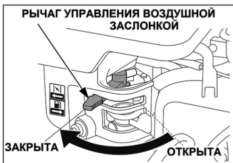
Рис. 9 Воздушная заслонка закрыта
