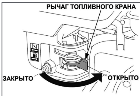
Рис. 8 Топливный кран открыт
