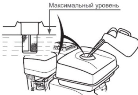
Рис. 7 Максимальный уровень топлива в топливном баке
