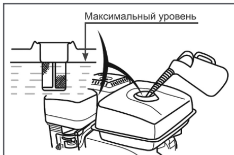
Рис. 9 Максимальный уровень топлива в топливном баке
