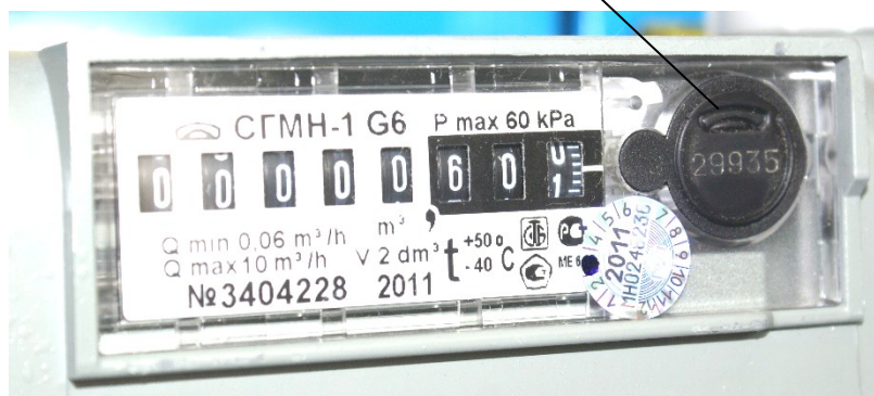
Рисунок5 – Расположение пластмассовой пломбы с порядковым номером, который записывается в паспорт счетчика
