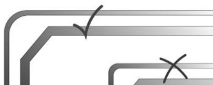
Рисунок 6 – Все изгибы должны иметь плавный переход
