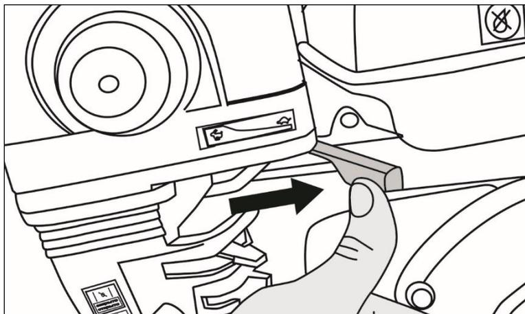
Рис. 10. Установка рычага газа в минимальное положение
