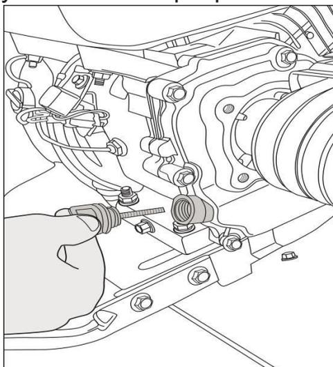
Рис. 2. Открывание крышки наливной горловины двигателя
