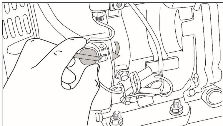
Рис. 9. Включение зажигания
