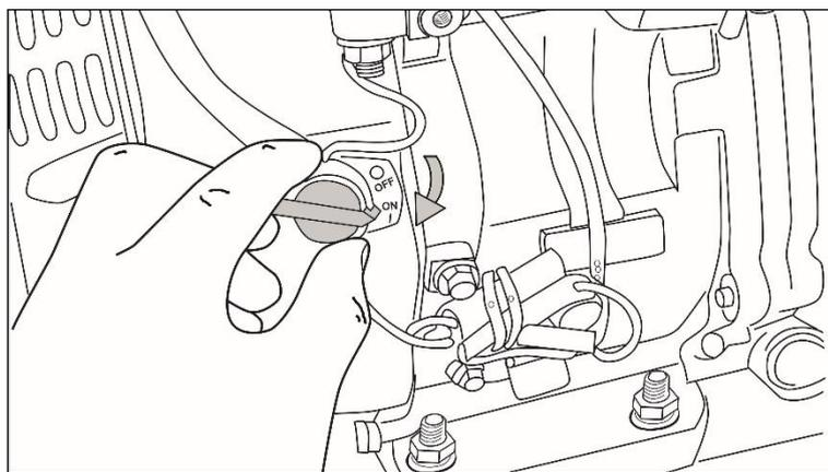
Рис. 9. Включение зажигания
