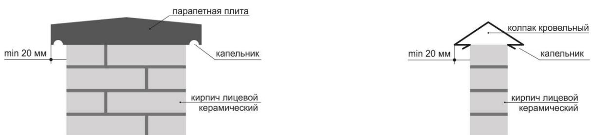
**Кровельное водоотведение** – водосточная система должна быть правильно спроектирована и смонтирована и исключать проникновение атмосферной влаги в стены. Особое внимание необходимо уделять защите от тающего снега и внутренним углам здания.
