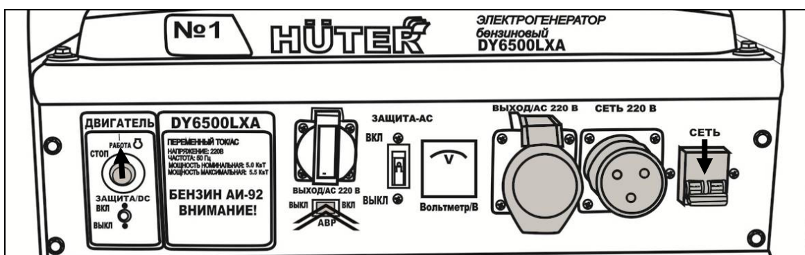
Рис. 21. Панель генератора с встроенным АВР.
