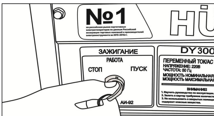
Рис. 17. Запуск двигателя электростартером
