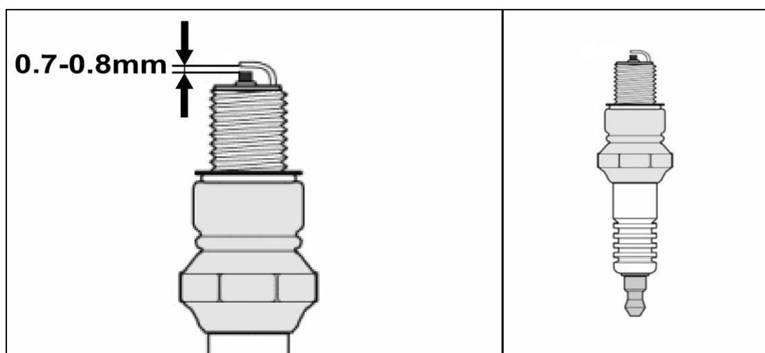
Рис. 25. Свеча зажигания
