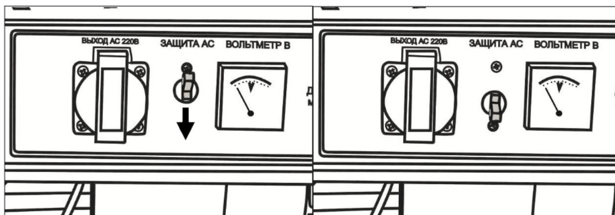
Рис. 12. Автоматический выключатель
