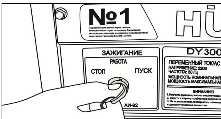
Рис. 17. Запуск двигателя электростартером
