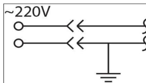
Схема 1. Заземление
