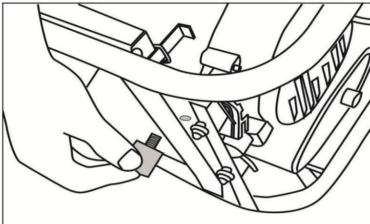
Рис. 2. Установка резиновых опор
