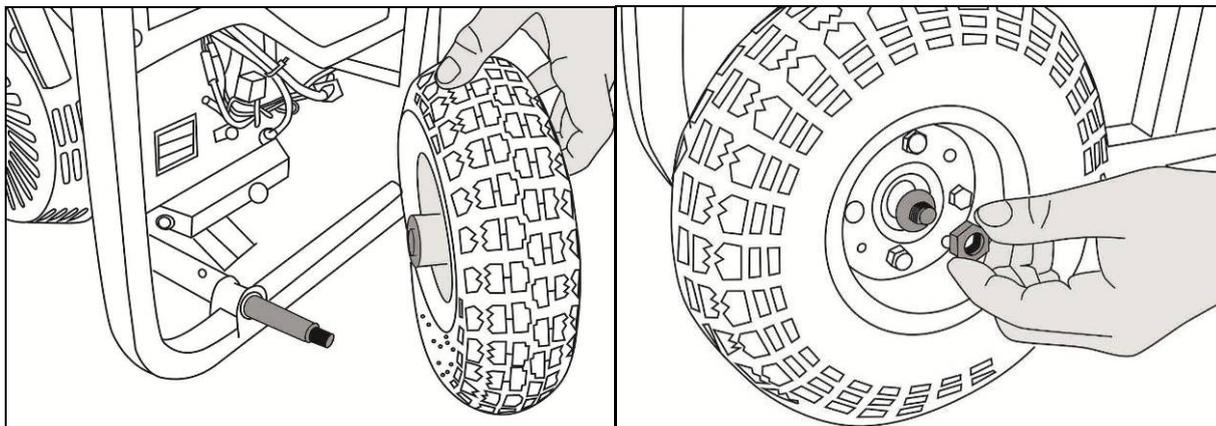
Рис. 4. Установка колёс
