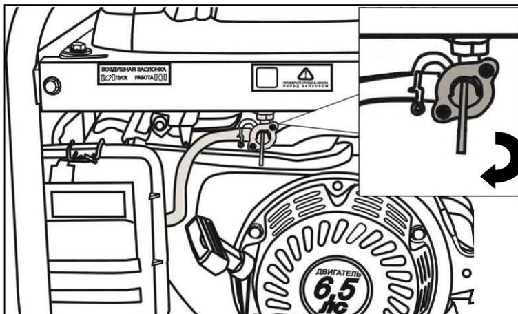
Рис. 13. Топливный кран
