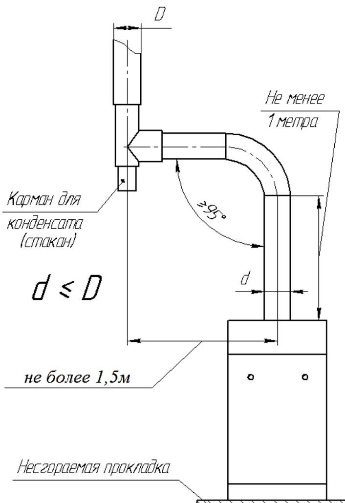
Рисунок 6 – схема монтажа дымохода.
