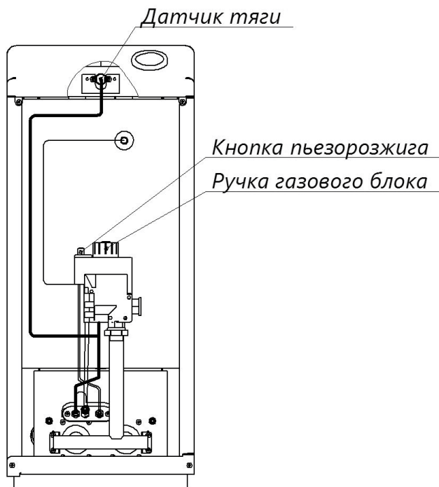
Рисунок 4 - Особенности котла с газовым блоком 630 EUROSIT
