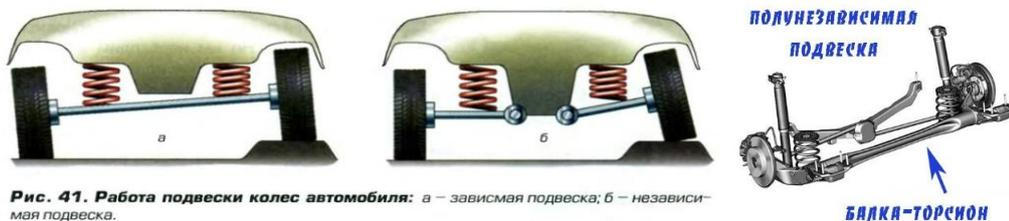
**Рис. 41. Работа подвески колес автомобиля:** а – зависимая подвеска; б – независимая подвеска.
