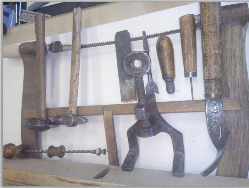
Инструменты для изготовления бочек
