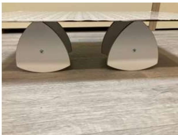
**Рис. 9** Колеса в форме треугольника Рёло, использующиеся в виде катков
