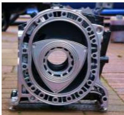
**Рис. 12** Роторно-поршневой двигатель
