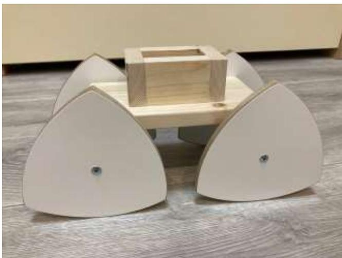
**Рис. 8** Машинка с колесами в форме треугольника Рёло
