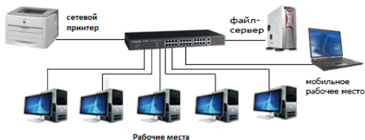
Рис. 2 Пример построения сети с выделенным сервером
