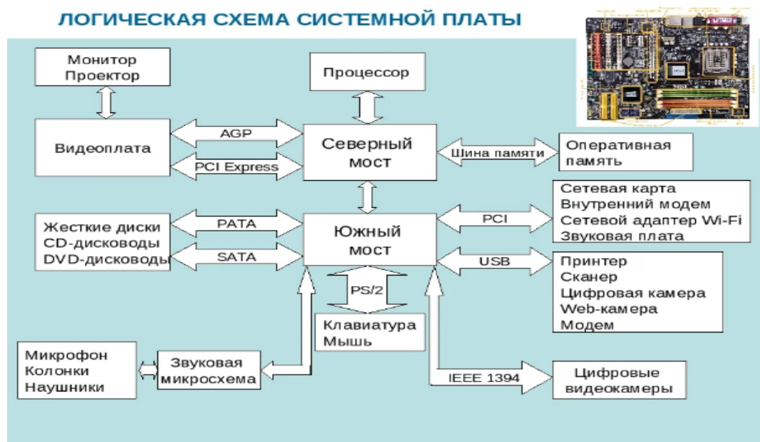
Рисунок 2. Логическая схема системной платы
